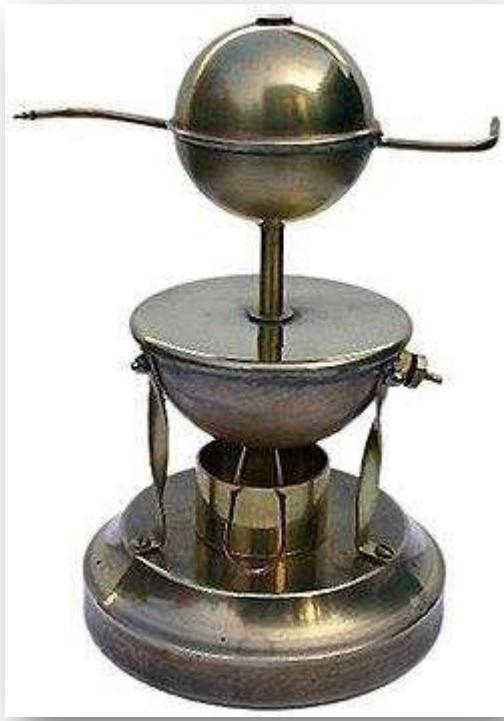
Slika 4. Heronova kugla ili eolipile
